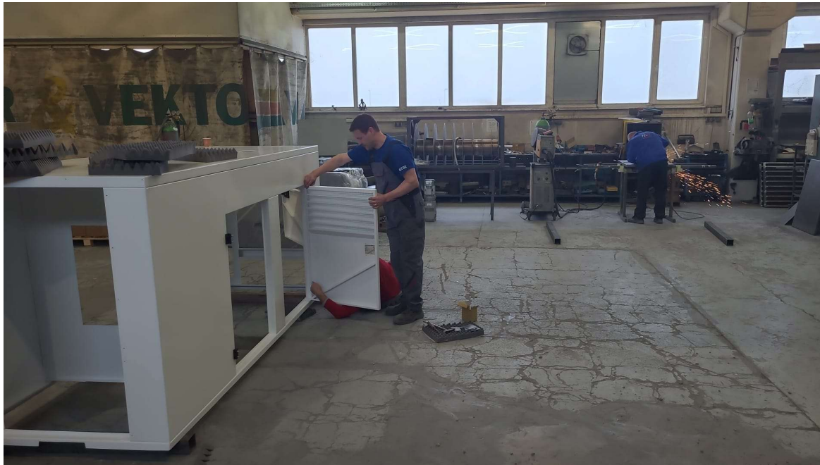
Notstromversorgung in Herstellung - Veranstaltungshalle (100 kVA)
