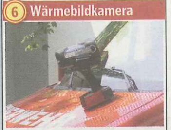
6 Wärmebildkamera Die Bilder der Kamera werden über Funk nach innen auf ein Display übertragen.
