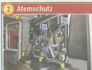
2 Atemschutz Der Wagen ist mit vier Sauerstoffkreislaufgeräten ausgestattet. (Regenerationsgeräte)
