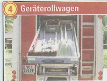
4 Geräterollwagen Zum leichteren Transport von Geräten. Dient auch zum Abtransport von Verletzten aus dem Tunnel.
