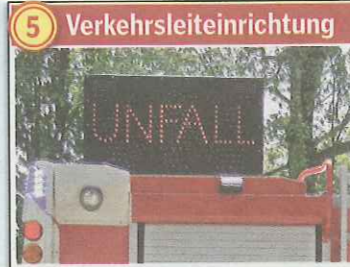
5 Verkehrsleiteinrichtung Statt einer kleinen Anzeige wie bei üblichen Einsatzfahrzeugen wird hier ein großes Schild aufgeklappt.
