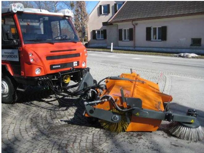
Durch das Aufrüsten mit **Fronthydraulik** und **Frontzapfwelle**, sowie der
