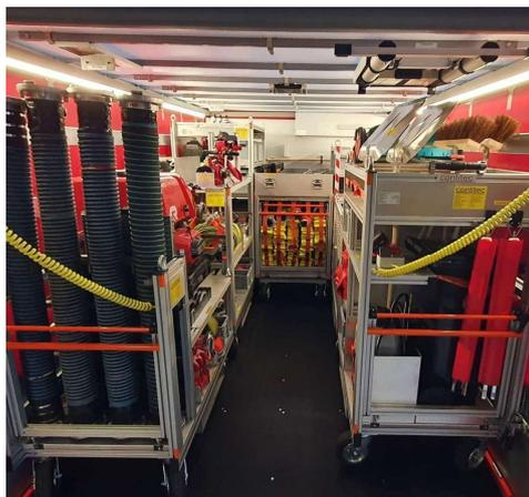
Neben sehen Sie, wie die Container am Fahrzeug, das mit Ladebordwand ausgestattet ist, gut untergebracht sind. Rasch steht alles beim Einsatz zur Verfügung; der Wechsel der Beladung ist so kein Problem. Wenige Handgriffe genügen.
