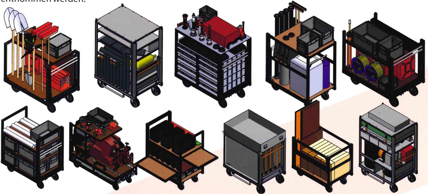
Für den Brandeinsatz stehen die Rollcontainer **Tragkraftspritze, Löschangriff, Schlauch, Atemschutz und Atemluftkompressor** zur Verfügung. Auf den Rollcontainern **Strom / Beleuchtung, Wasserschaden, Ölschaden, Heavy Resuce, Rüstholz und Schanzwerkzeug** sind alle weiteren Gerätschaften verstaut, die im Zuge von Technischen Einsätzen Verwendung finden.
